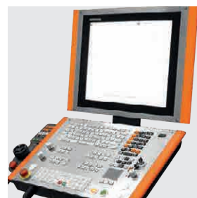
Volba řídicího systému HEIDENHAIN nebo FANUC
