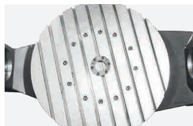
Otočný stůl s paralelními drážkami
