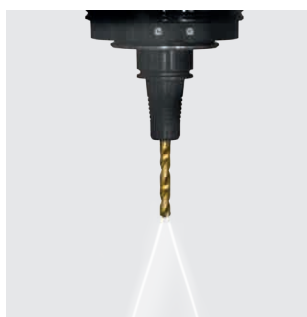
Chlazení vzduchem / kapalinou skrze vřeteno
