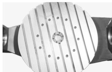
Drehschwenktisch mit parallelen Nuten
