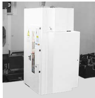
Werkzeugmagazin HSK-A/T63: 120 Werkzeuge
