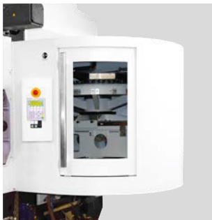
Werkzeugmagazin HSK-A/T100: 30 Werkzeuge HSK-A/T63: 45 Werkzeuge
