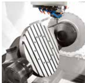
双端支撑和力矩电机驱动的回转工作台
